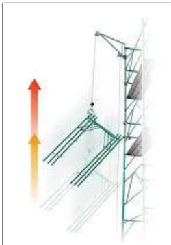
**Solo se sono stati ancorati al ponteggio degli apparecchi di sollevamento: è stato effettuato il raddoppio montanti (per tutta altezza)?**
