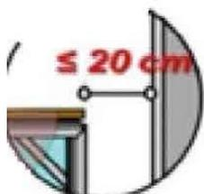
**Solo se la distanza tra impalcati e l'opera in costruzione è > 20 cm: sono stati realizzati il parapetto e la tavola fermapiede ovvero le mensole a sbalzo?**
